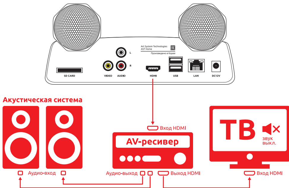
Рис. 2 Примерная схема подключения к ресиверу домашнего кинотеатра
