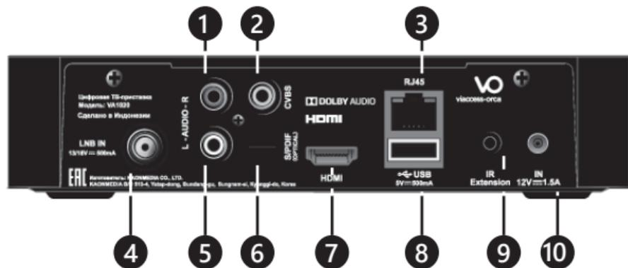
Вид задней панели ТВ-приставки с указанием разъёмов
